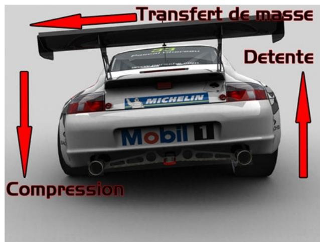
De fait on charge l'avant gauche encore d'avantage, sur les 600kg de l'avant qui était uniformément répartie 300 à G et 300 à Dr on se retrouve avec disons 500kg à G et 100KG à dr.
