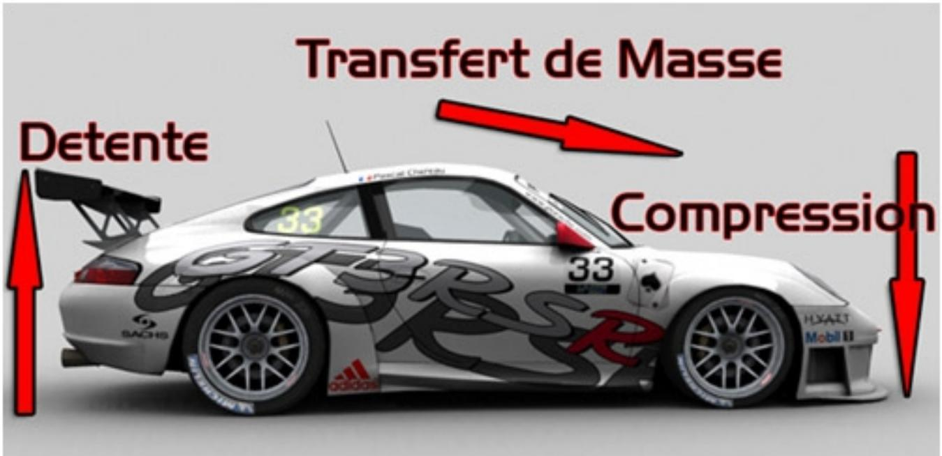
A l'accélération c'est l'inverse la masse se transfère vers l'arrière et on charge le train AR en délestant l'avant, au niveau des suspensions on compresse l'arrière et on détends les suspensions avant
